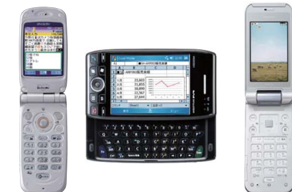
MOVA (SH505i)。 搭载100万像素CCD 摄像机和系统液晶 (2003年)
