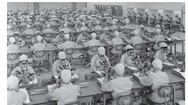
使用显微镜认真进行后半工序的半导体工厂员工
